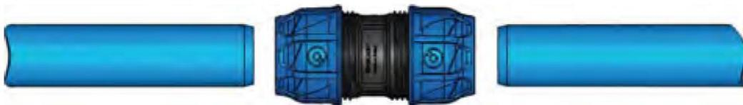
4. Вставить трубу в фитинг до упора (\*) и гайки затянуть.
