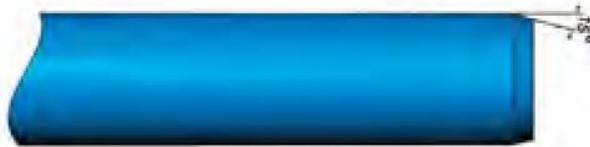
2. Нанести на трубе метку (или установить ограничительный хомут) на расстоянии от торца трубы до метки (или края хомута), равном глубине фитинга.
