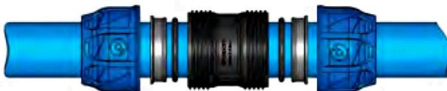
5. Закрутить гайки фитинга вручную, чтобы держатель и уплотнительное кольцо установились в посадочное место фитинга.
